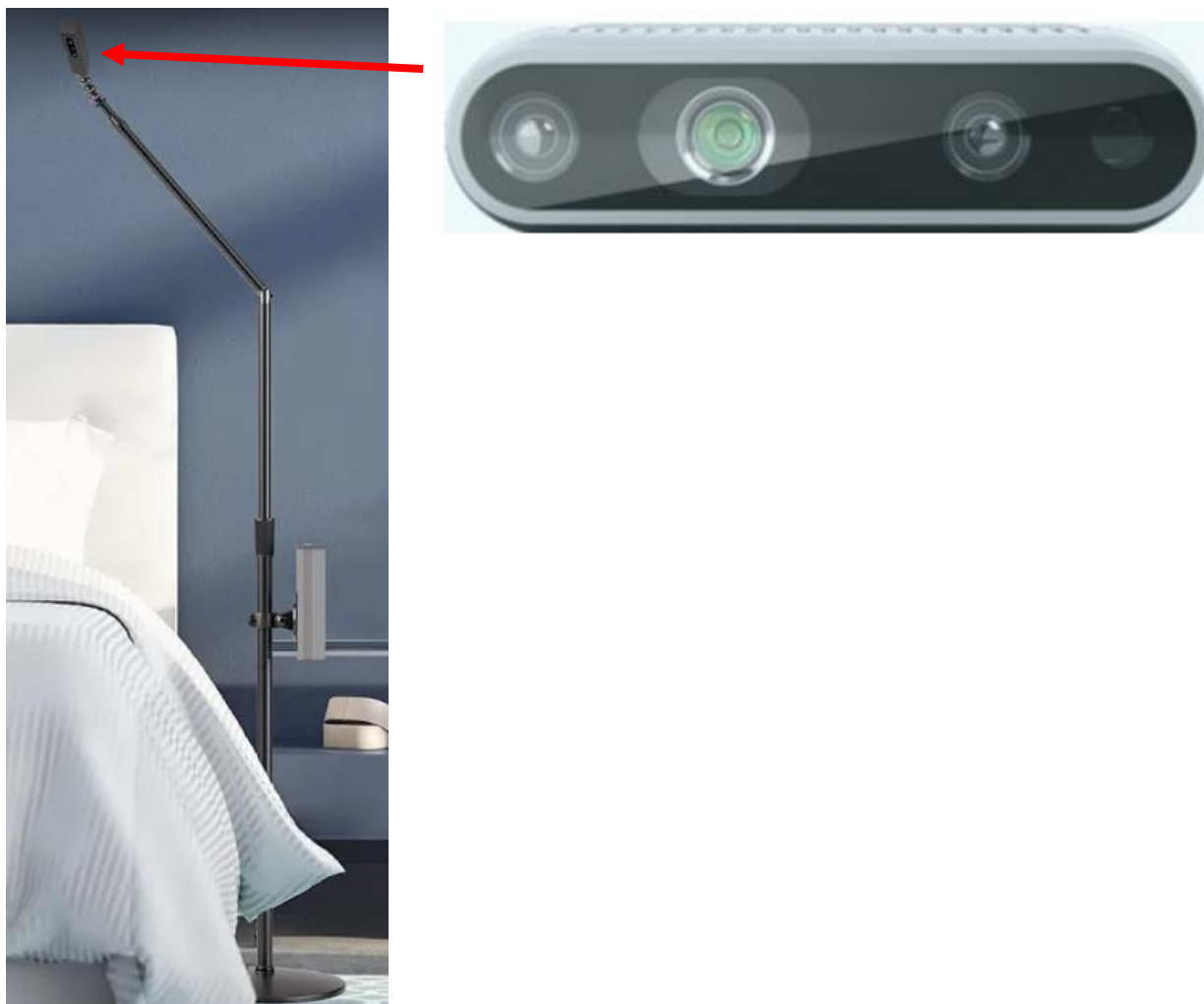
Figur 1: Nelli® datamaskin med kamera og mikrofon, plasseres over pasientens seng for video og lydopptak av anfall [2, 4]
